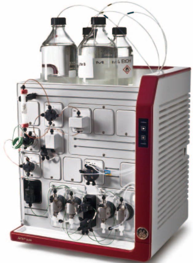
图 1. ÄKTA pure 是一种用于蛋白质、肽和核酸在实验室规模的可靠纯化的灵活层析系统。
