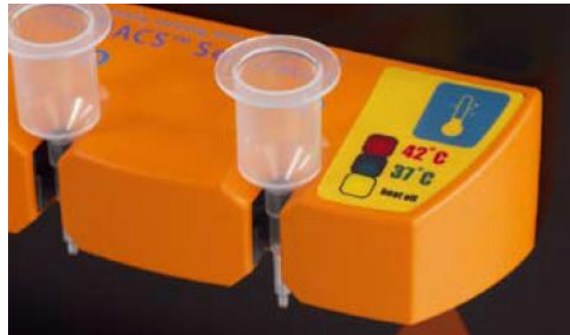
图 2. thermoMACSTM 分选器可被加热到 37°C 或者 42°C
