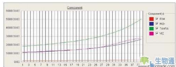
图 1：多组分图显示 Rox™信号和报告染料信号一同抬起，结果指示存在蒸发
