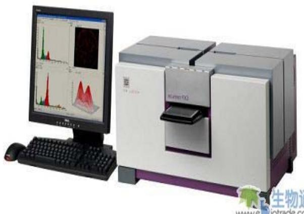
Acumen eX3 激光扫描荧光微孔板细胞分析仪是结构紧凑的高通量化高内涵台式仪器，可提供三种波长的激发光。这种设计，尤其当仪器是全集成的时候，有利于在宽范围内以高通量进行高内涵分析。专利的信号阈值方法能提供实时 (“on-the-fly”) 细胞分析，大大缩小了数据文件的大小——在高通量(HTS)筛选模式下数据文件仅为 50Kb 左右。
