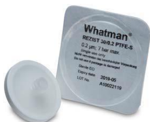
ReZist (PTFE 材质, 可过滤腐蚀性溶剂)
