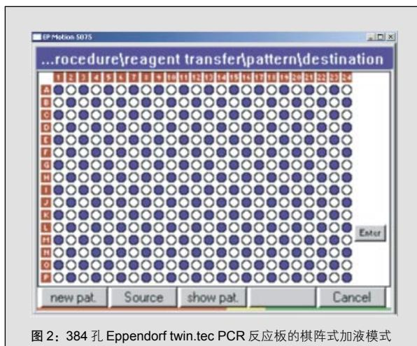
图 2：384 孔 Eppendorf twin.tec PCR 反应板的棋阵式加液模式
