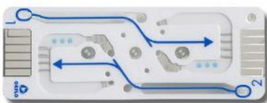
每次测量仅需 8 秒，仪器就能带来细胞大小、细胞数量以及活细胞/死细胞的比例 (Moxi Viability Index)，这些信息对研究人员分析细胞培养情况很重要。Moxi Z 能够对直径 2-34  $\mu\text{m}$  的细胞进行计数，适用于哺乳动物细胞、血小板、酵母及其他。由于检测下限为 2  $\mu\text{m}$ ，也就避免了漏掉一些细胞的风险。每次测量需要 75  $\mu\text{l}$  样品，其中细胞浓度范围在 3,000-500,000 个细胞/ml。
