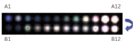
图2: 每轮的24个组分收集在一个微孔板中在Typhoon上对Cy2(激发波长488 nm, 发射滤光片520 BP40)、Cy3(激发波长532 nm, 发射滤光片580 BP30)和Cy5(激发波长633 nm, 发射滤光片670 BP30)成像。图像显示第4轮运行(对照组5和疾病组10)的所有三个通道重叠图。
